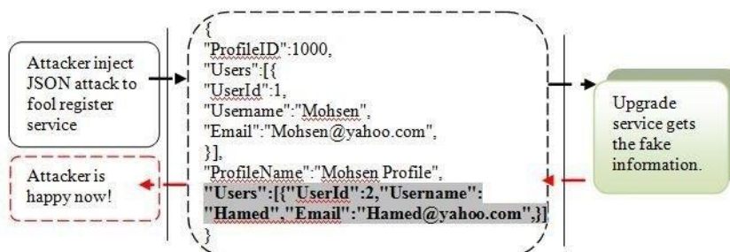
Рисунок 4. Схема виконання JSON Injection
