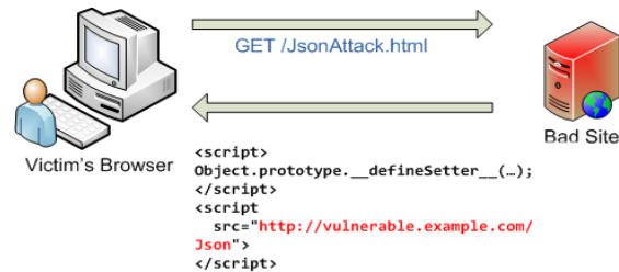
Рисунок 5. Схема виконання JSON Hijacking
