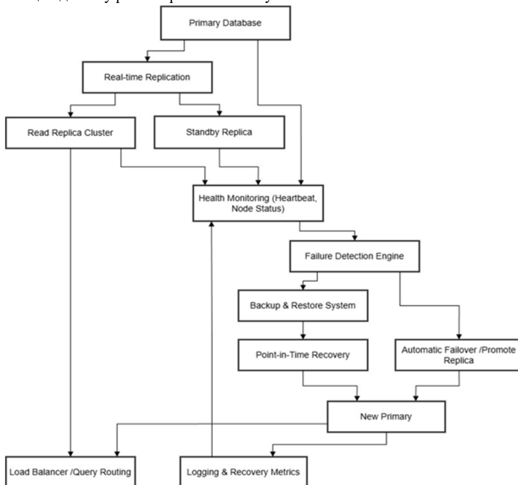
Рисунок 4 – Модель відмовостійкості та доступності БД
