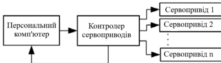
Рисунок 1 – Схема моделювання САУ на комп'ютері
