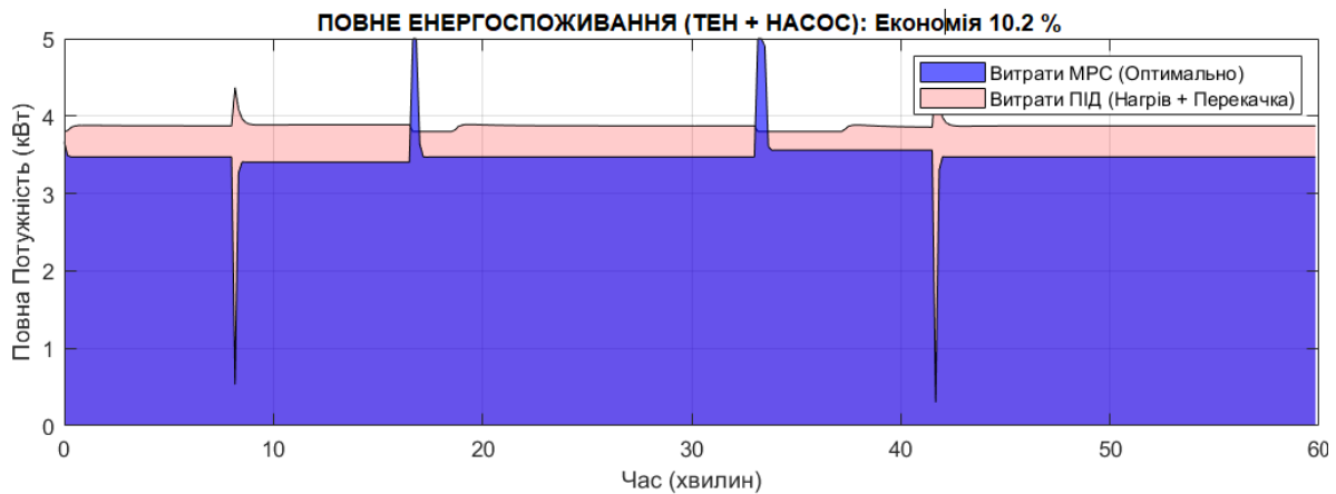
Рисунок 2 - Порівняльна діаграма споживання повної потужності (нагрів + перекачка)
