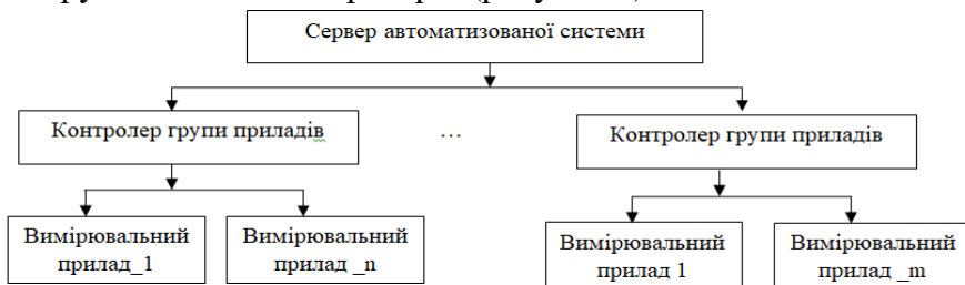
Рисунок 1 – Структурна схема автоматизованої системи вимірювання та контролю
